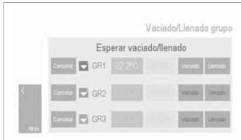
Pulsaremos el botón de “Vaciado” y, a continuación, empezará a vaciarse el grupo o grupos mediante la apertura de la electroválvula de vaciado y la de purga.
