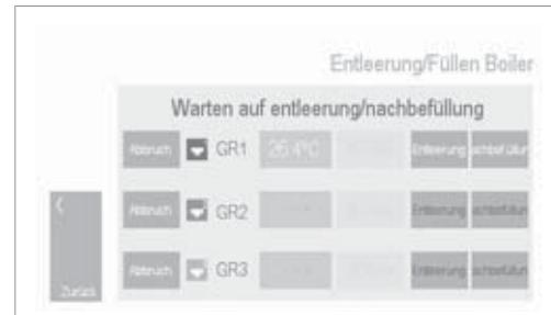
Auf die Taste „Entleeren“ drücken und anschließend beginnt die Entleerung der Gruppe oder Gruppen durch das Öffnen des Elektroventils zum Ablassen und Entlüften.
