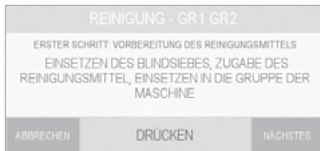
Wenn das Reinigungsmittel in den Blindfilter gegeben und im Filterhalter der Gruppe eingesetzt wurde, erneut auf „weiter“ drücken, um zur Anweisung Nr. 2 zu kommen, die uns anzeigt, dass die mittlere, blinkende Taste der zu reinigenden Gruppe gedrückt werden muss, um den Waschvorgang zu starten.
