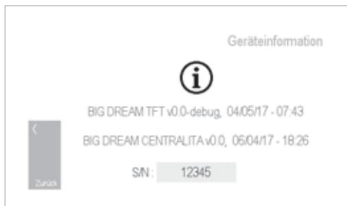
Information der Seriennummer der Maschine, Hardwareversion und Softwareversion der elektronischen Kontrolleinheit.
