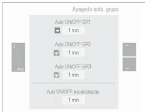
Para volver a activar el grupo, basta con pulsar cualquier tecla de la botonera del grupo desactivado y volverá a calentar, hasta la temperatura de servicio programada.
