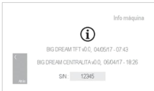
Información del n° de serie de la máquina, versión del hardware y del software de la centralita electrónica.
