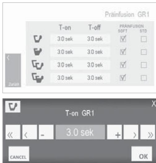
In beiden Fällen haben wir eine „on“-Zeit, während der das Wasser den Kaffee nach und nach befeuchtet und eine „off“-Zeit, in der der gemahlene Kaffee komplett befeuchtet wird, bevor der Brühvorgang mit einem Druck von 9 bar beginnt.
